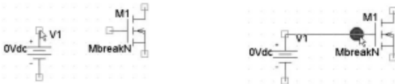
図 m1.16 電源素子 V1 の + 端子をクリックした後、MOSFET のゲート端子をクリックして配線する
